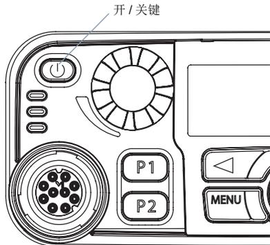
发出一声短提示音，指示开机检测成功。
