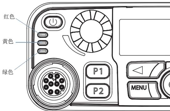
**红灯闪烁** – 对讲机正在接收紧急呼叫发射信号或开机后自检失败。
