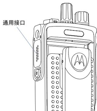
将护盖的卡钩插入通用接口上的卡槽中。按护盖将下面的锁片正确卡入射频接口。
