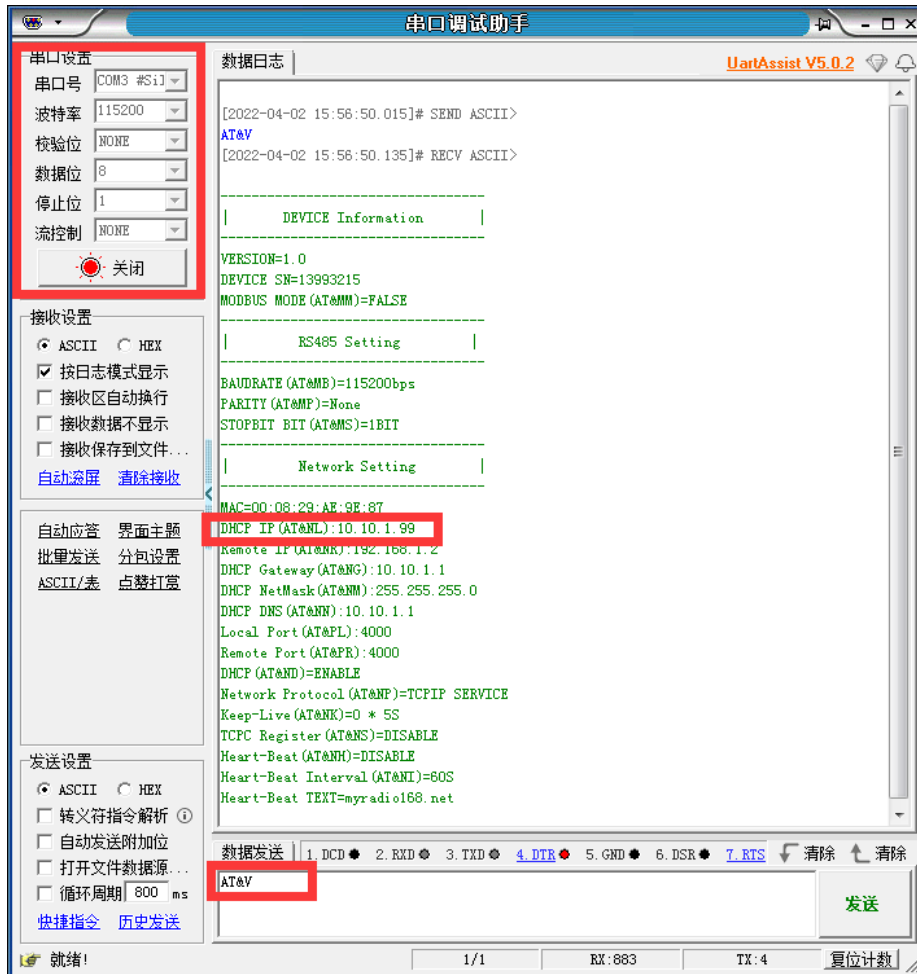
设备默认 DHCP 自动获取 IP 地址，通过 RS485 接口 AT 指令查看设备当前 IP 地址
